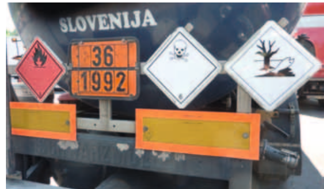
Beispiel für die Kennzeichnung von Gefahrguttransportfahrzeugen.
